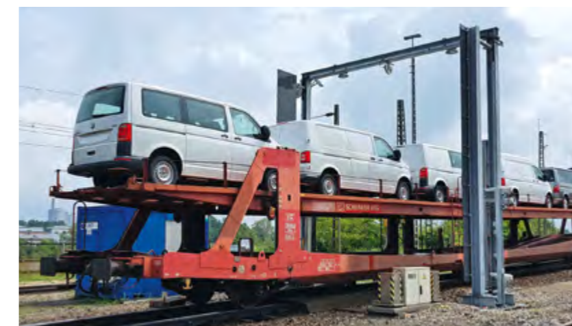
Künftig durchfahren Güterzüge eine Kamerabrücke, die von allen Seiten Bilder der einzelnen Wagen aufnimmt. So können Schäden automatisch erkannt und gemeldet werden.
