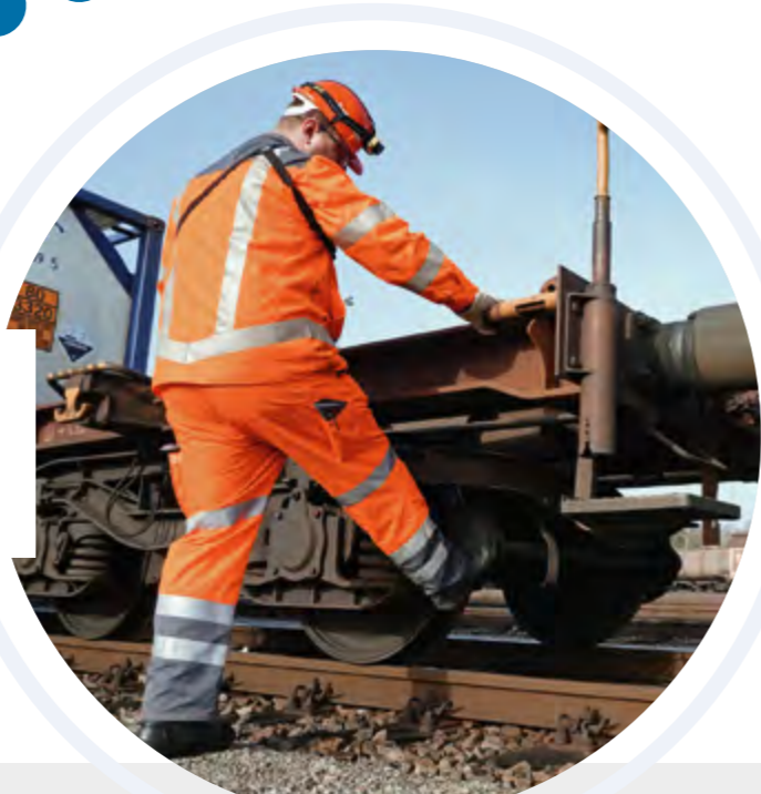
Die Digitale Automatische Kupplung (DAK, I) wird den Schienengüterverkehr revolutionieren. Derzeit ist viel zeitaufwendige Handarbeit gefordert – wie bei der Bremsprüfung (r.).
