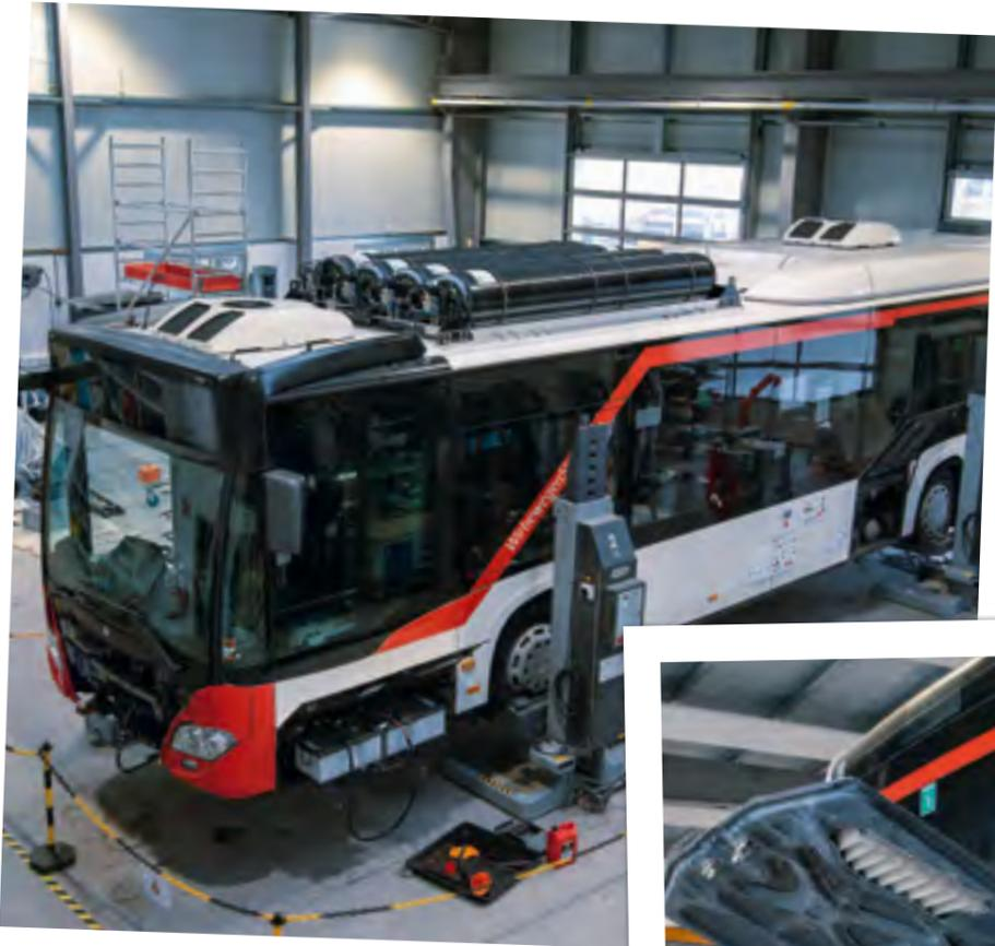
*Umrüstung: Auf dem Dach trägt der Bus der Uckermärkischen Verkehrsgesellschaft bereits die markanten druckdichten Stahlflaschen für den Wasserstoff. Wo beim Diesel der Motor saß, werden die Brennstoffzelle und die Batterien eingebaut.*
